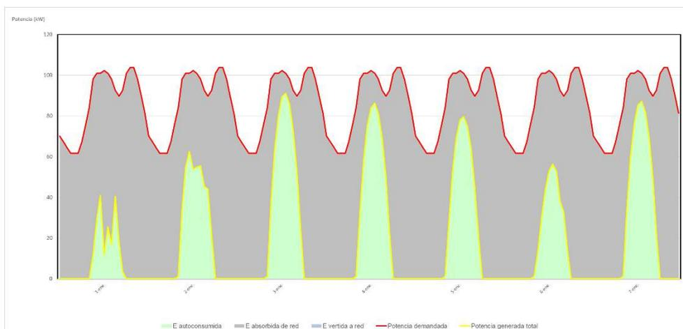
En la gráfica anterior se representa la curva de generación de un sistema FV que no da lugar a excedentes, en el que se logra un 100% de aprovechamiento de la energía producida (autoconsumo) al situarse la curva de producción por debajo de la curva de demanda agregada de los consumidores. Esta sería la situación típica de una comunidad energética muy numerosa en la que la demanda agregada supera ampliamente la producción del sistema FV.
